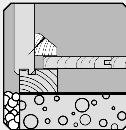
**4** Verbindungsstrook in de groef aanbrengen.
